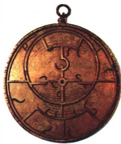
Астролябия — прибор для измерения углов с целью определения местонахождения корабля по расположению звезд.
