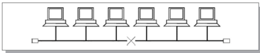
Рисунок 67. Обрыв кабеля в сети с топологией шина
