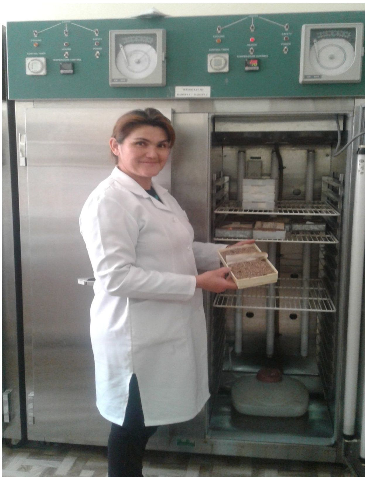
Расм 24. Ўздавуруғмарказ уруғ синов лабораторияси технологи Н.Шарипова уруғ униб чиқиш қувватини аниқлаш учун ванночкани термостатдан олмоқда.
