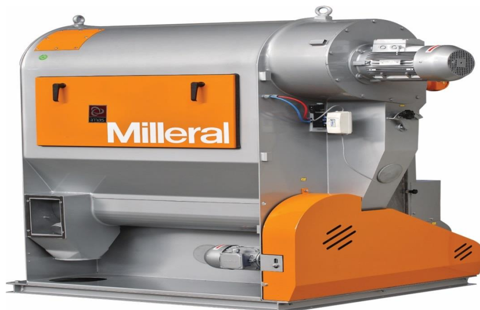
79-rasm. Radial tarar donni ustki qismiga ishlov berish uskunasi.
