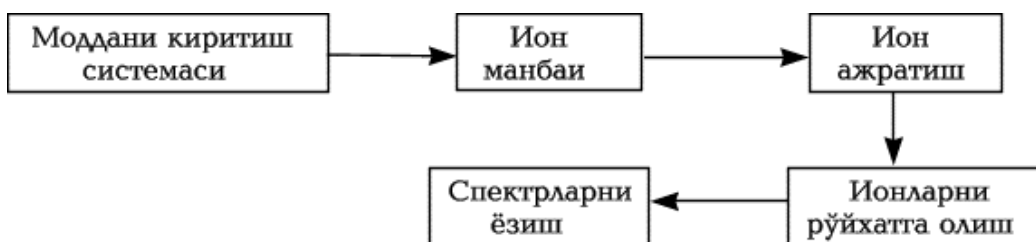
Mass-spektrometrning sxematik tasviri.
