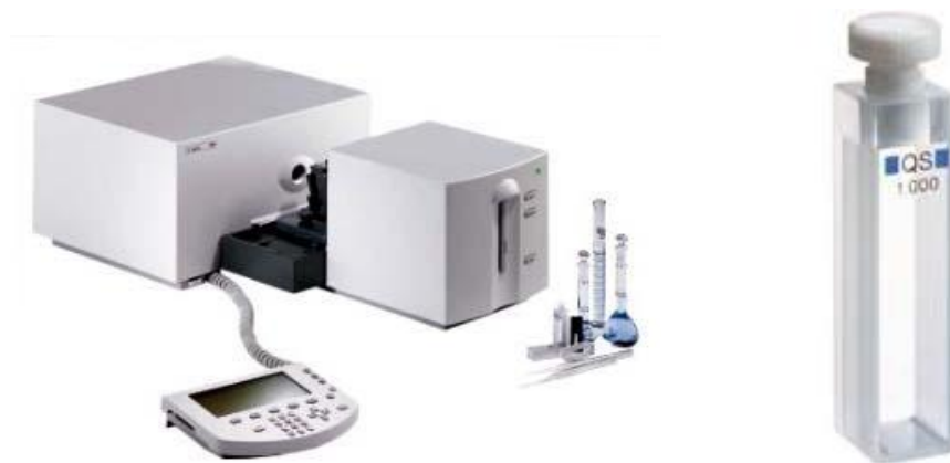
1-rasm. Spektrofotometr – Agilent 8354 va uning kyuvetasi.
