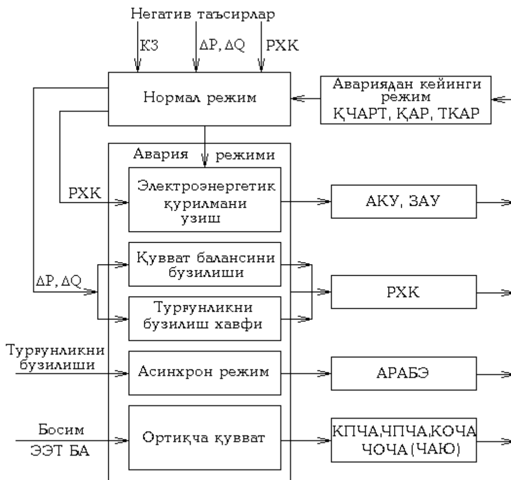
4.8-Расм. Аварияга қарши автоматикани функционал схемаси.
