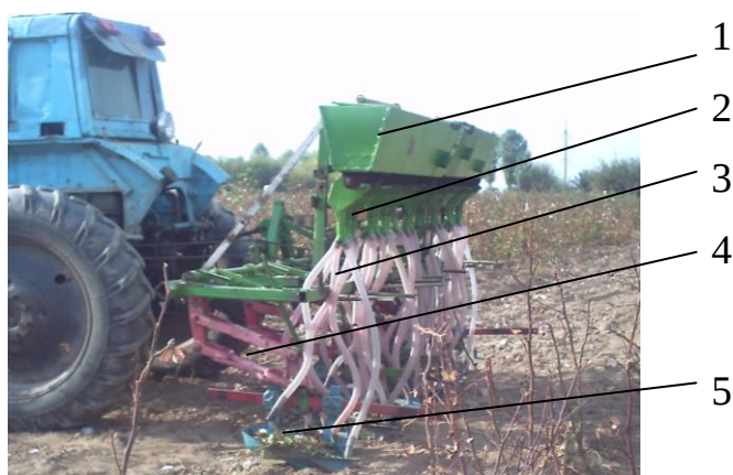
1-дон сифими; 2-ғалтакли уруғ тақсимлагич; 3-уруғ ўтказгич; 4-паралеллограмм механизми; 5- пичоқли сирпанма экич. 63-расм. Экспериментал сеялканинг тажриба нусхаси
