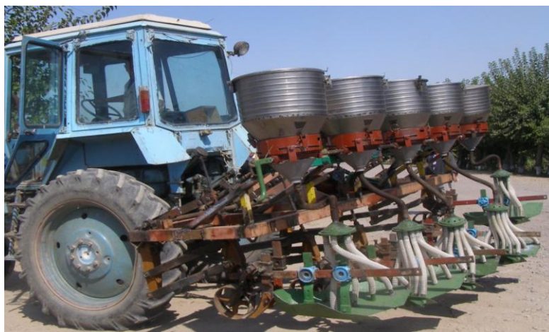
83 - расм. Ёўза қатор орасига кузги буғдой экиш агрегатининг тажриба варианти
