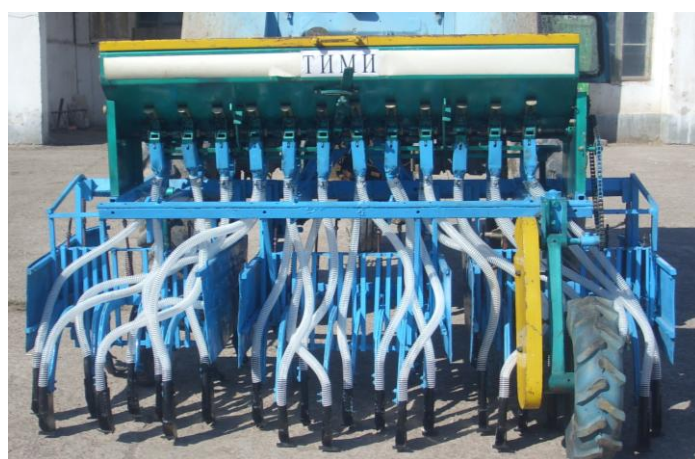
49-расм. Ѓўза қатор ораларига кузги буғдой экувчи янги сеялканинг тажриба нусхаси
