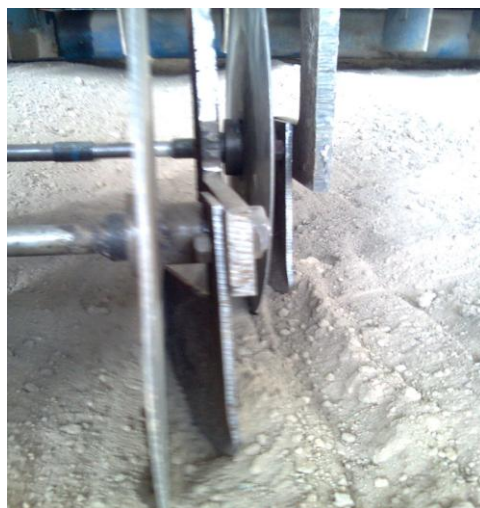
47-расм. Тик ва ёнига эгатча очувчи пичоқ ўрнатилган экспериментал эккич билан эгатча очиш
