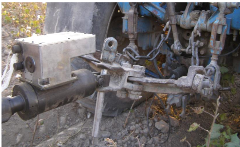
81-расм. Агрегатнинг қаршилигини аниқлашда қўлланилган работамер
