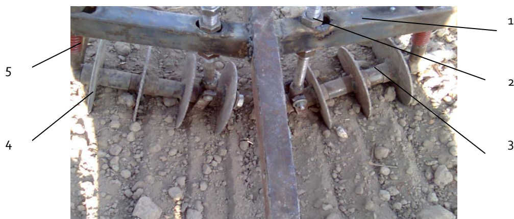
1- дисклар тўпламининг қаноти; 2- ростловчи механизм; 3- дисклар қотириладиган ўқ; 4-диск; 5-пружина.
