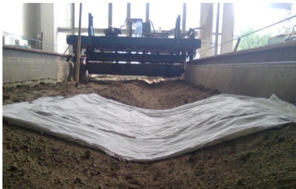
46-расм. Тупроқ каналида ғуза қатор орасига мослаштирилган пушта тайёрлаш жараёни
