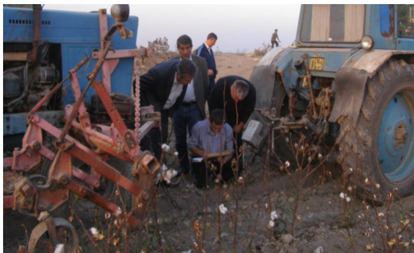
82 - расм. Агрегатни тортишга қаршилигини аниқлаш жараёни
