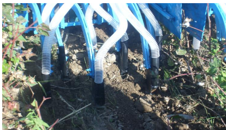
50- расм. Экиш сифатининг бузилиши ва экичлар олдида бегона ўтлар ва ғўза баргларининг тўпланиб қолиши
