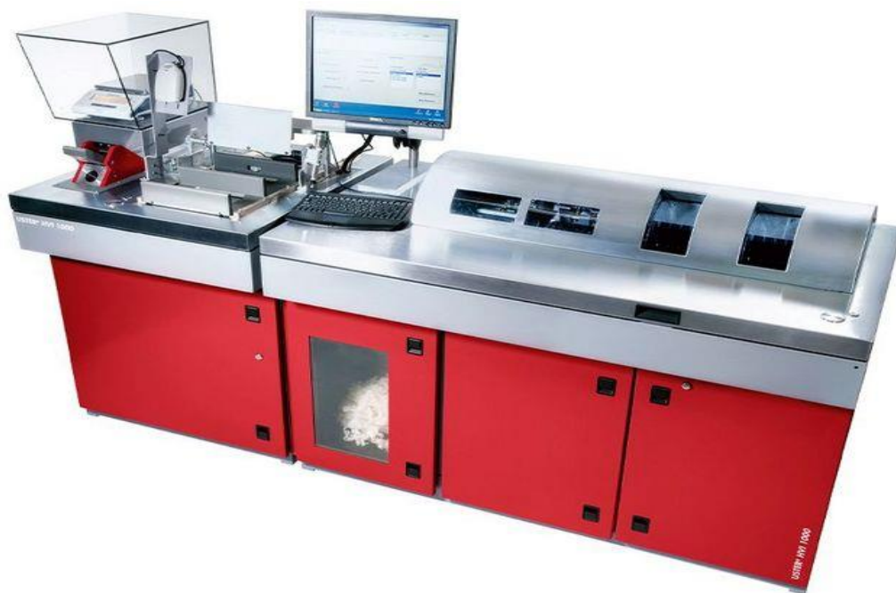
89-rasm. Uster HVI 1000 tolani aniq tasniflash tizimi.
