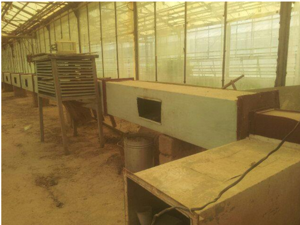
59-rasm. Garmsel shamolni ta'minlash uchun qo'lbola yig'iladigan qurulma qismlari.
