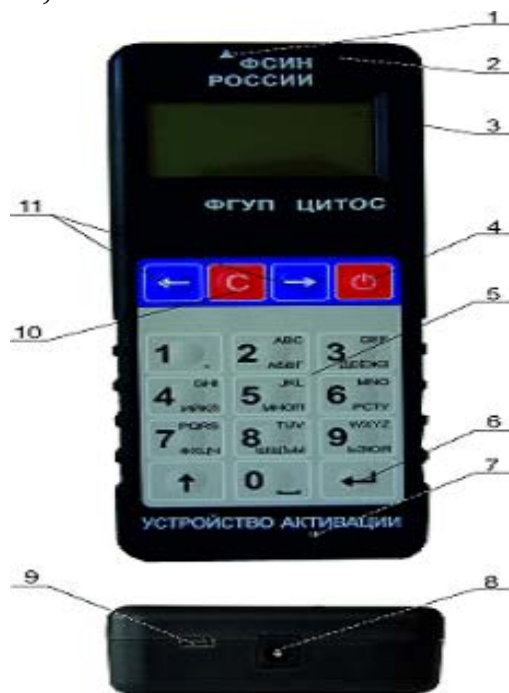
Рис. 31. Устройство активации: 1 – стрелка совмещения с контрольным устройством; 2 – динамик; 3 – индикатор работы; 4 – выключатель питания; 5 – клавиатура; 6 – кнопка подтверждения выбора команды; 7 – индикатор заряда аккумулятора; 8 – разъем для подключения источника питания; 9 – разъем для подключения кабеля связи с ПЭВМ; 10 – кнопка «СБРОС»; 11 – кнопки управления
