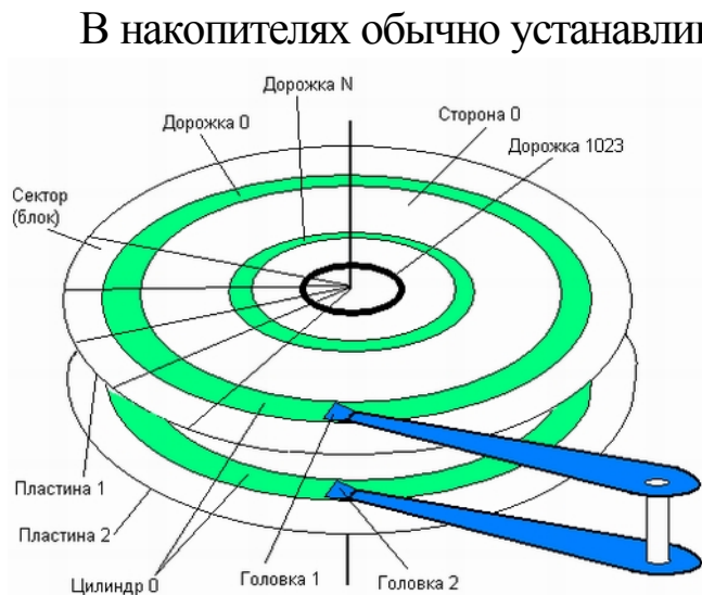
Рис. 14. Дорожки, секторы и цилиндры накопителя на жестких дисках
