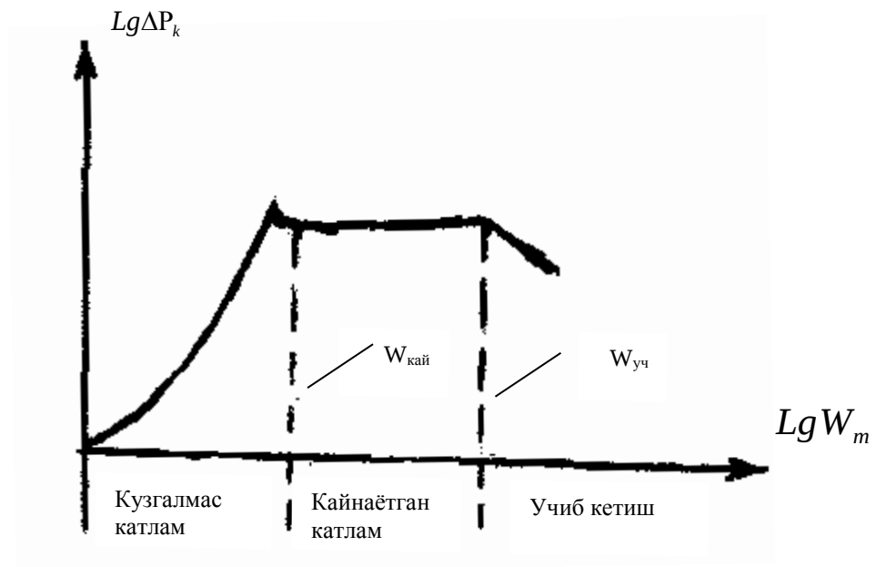
5.2-rasm. Donador qatlam gidravlik qarshiligi bilan gazning mavhum tezligining bog‘liqligi.
