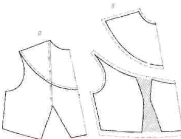
1.42-рasm, б. Айлана шаклдаги кокеткали кўкрак қисми чизмаси тузилиши: а – олд бўлакка кокетка чизигини солиш; б – тайёр андаза
