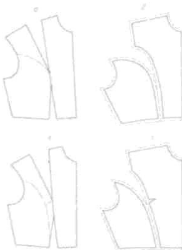
1.19-расм, б. Енг ўмизидан бўртмага виточкаларни ўтказиш: а – олд бўлакка бўртма чизиғини солиш; б – тайёр андаза; в – енг ўмизи томонига, олд бўлакка силжитилган бўртма чизиғини солиш; г – тайёр андаза
