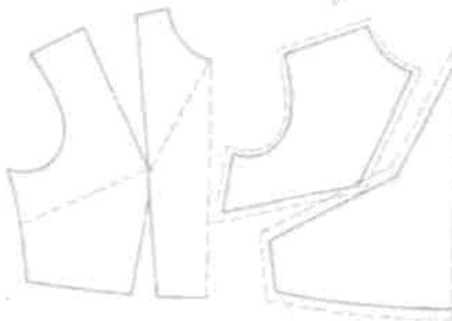
1.21-расм, б. Виточкани ёқа ўмизига ўтказиш: а – бўртма чизиғини солиш; б – тайёр андаза
