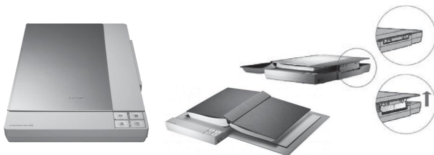
4.16-rasm. Skanerning tashqi ko‘rinishi va qopqog‘ini qotirish konstruksiyasi.
