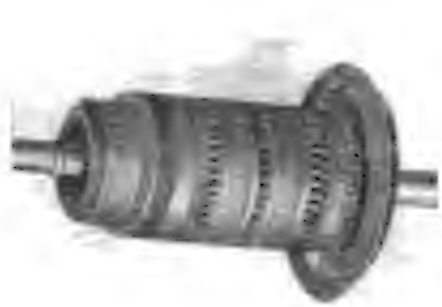
Рис. 1-12б. Якорь машины постоянного тока в готовом виде
