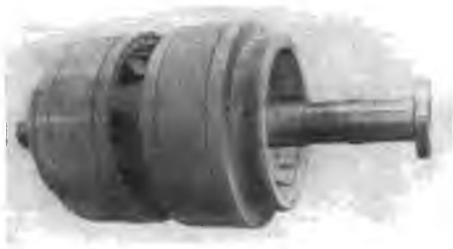
Рис. 1-13. Якорь двухъякорной машины постоянного тока большой мощности
