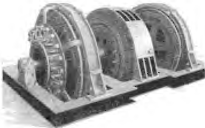
Рис. 1-20. Преобразовательный агрегат, состоящий из синхронного двигателя типа СМ 8100-375, 8100 кв-а, 6000 в, 375 об/мин и двух генераторов постоянного тока типа ГП 3600-375. 3600 квт. 800 в, 375 об/мин
