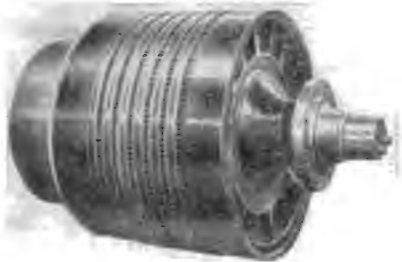
Рис. 11-3. Гладкий якорь с пластмассовыми сегментами и уложенной и закрепленной бандажами обмоткой
