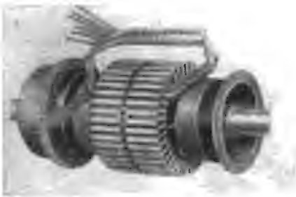
Рис. 1-12а. Необмотанный якорь машины постоянного тока
