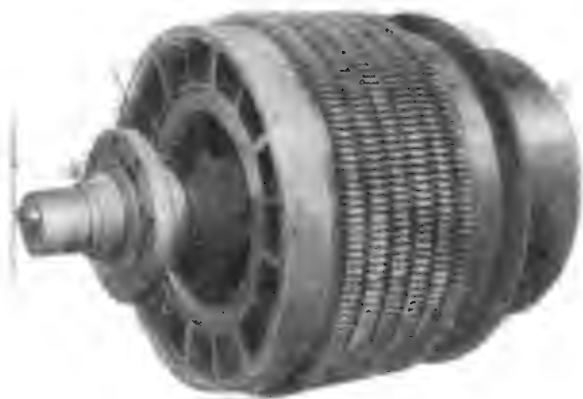
Рис. 11-2. Гладкий якорь с пластмассовыми сегментами до укладки обмотки
