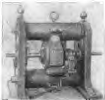
Рис. В-6. Электрическая машина Грамма, первая промышленная модель с самовозбуждением
