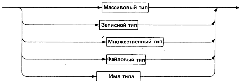
Рис. 6.2. Синтаксическая диаграмма для Составного типа
