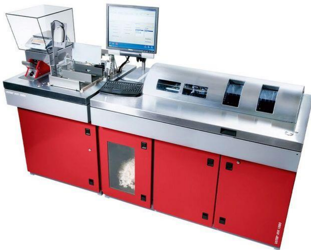
Фото 89. Система точной классификации волокон Uster HVI 1000.
