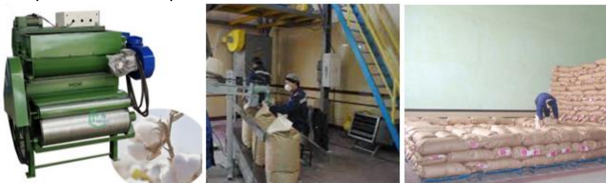
Фото 130, 131, 132. Калибровка-сортировка, упаковка и размещение мешков с семенами на поддонах.
