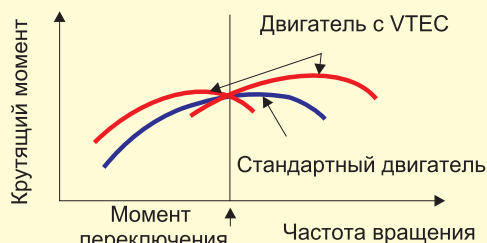
Рис. 29.23. Оптимизация газообмена в области низких и средних оборотов
