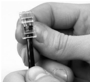
10.7-rasm. O'tkazgichlarni konnektorga joylash.
