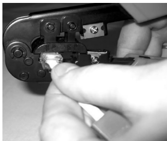
10.8-rasm. Ish quroli yordamida konnektorni siqish.
