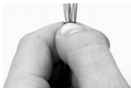
10.6-rasm Simni to'g'rilab kesamiz.
