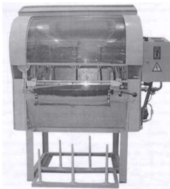
12-rasm. FY518 mini xom ipakni qayta o'rash dastgohini umumiy ko'rinishi.
