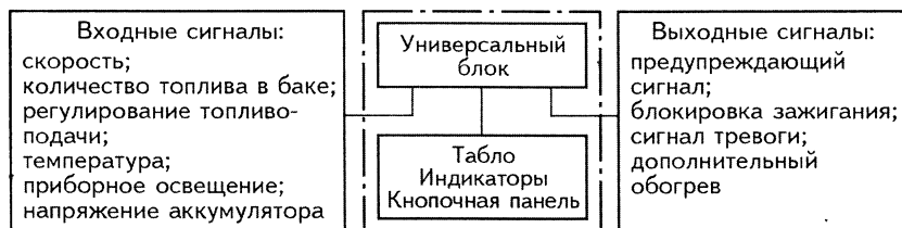
Рис. 5.29. Структурная схема бортового компьютера
