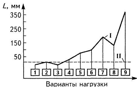
Рис. 6.57. Изменение границы освещенной зоны автомобиля при ближнем свете в зависимости от нагрузки автомобиля:
