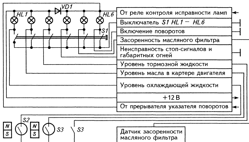
Рис. 5.21. Электрическая схема блока управления и сигнализаторов
